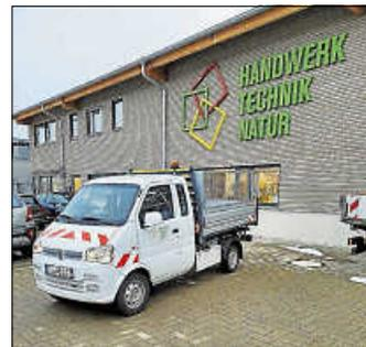
Bereits im vergangenen Jahr wurde das erste reine **E-Fahrzeug** geliefert. Das Leasingfahrzeug wird vor allem zur Müllrunde eingesetzt. Das Fahrzeug ist hierfür sehr gut geeignet, da das Starten und Abstellen des Motors anders als bei einem Verbrenner bei jedem Halt entfällt.
